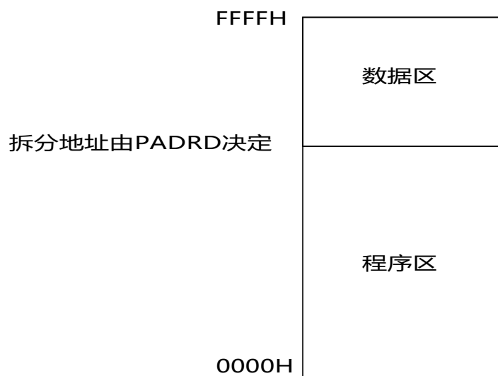
图 7-3-1 64K Flash 存储器结构
